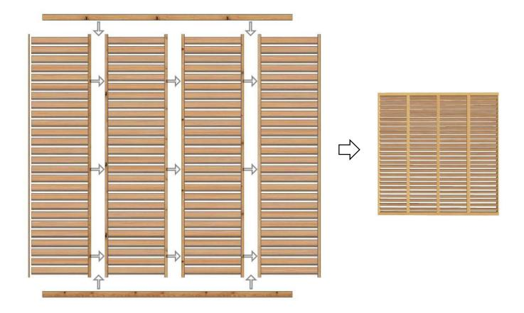
Die 4 vormontierten Elemente werden mit den mitgelieferten 36mm Schrauben jeweils mit 3 Schrauben im oberen, mittleren und unteren Bereich verbunden. Danach wird das Ober- und das Unterprofil mit den 80mm Schrauben auf Höhe der Seitenteile der Segmente mit diesen verschraubt.
