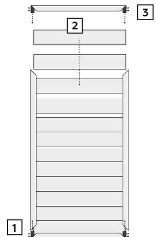
Um das Tor fertigzustellen, montieren Sie im letzten Schritt die Drückergarnitur mittels des beiliegenden Montagematerials und die Ladenbänder mit Hilfe der Schrauben, Unterlegscheiben und Kugelkopfmuttern an dem Tor.
