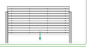
Stecken Sie die vier Aluröhrchen in die Bohrungen an der Oberseite des Halbelementes.
